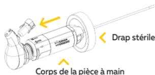
7. **PERSONNEL CIRCULANT** : Tout en connectant l'engrenage de l'instrument dans le corps de la pièce à main, insérez le cache d'engrenage dans le corps de la pièce à main, et tournez le cache d'engrenage dans le sens contraire des aiguilles d'une montre jusqu'à verrouillage.
