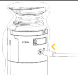
13. **ASSISTENTE DI SALA OPERATORIA:** Collegare il connettore femmina prossimale del cavo di alimentazione DC all'adattatore di alimentazione e inserire l'adattatore di alimentazione nella presa di corrente.
