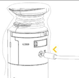
13. **PERSONA CIRCULANTE:** Conecte el conector hembra proximal del cable de corriente continua al adaptador de corriente y conecte el adaptador de corriente al enchufe de pared.
