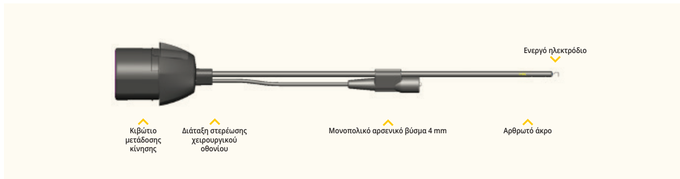
ΕΙΚΟΝΑ 1: ΣΧΗΜΑΤΙΚΗ ΑΠΕΙΚΟΝΙΣΗ ΤΟΥ ΜΟΝΟΠΟΛΙΚΟΥ ΑΓΚΙΣΤΡΟ HANDX™
